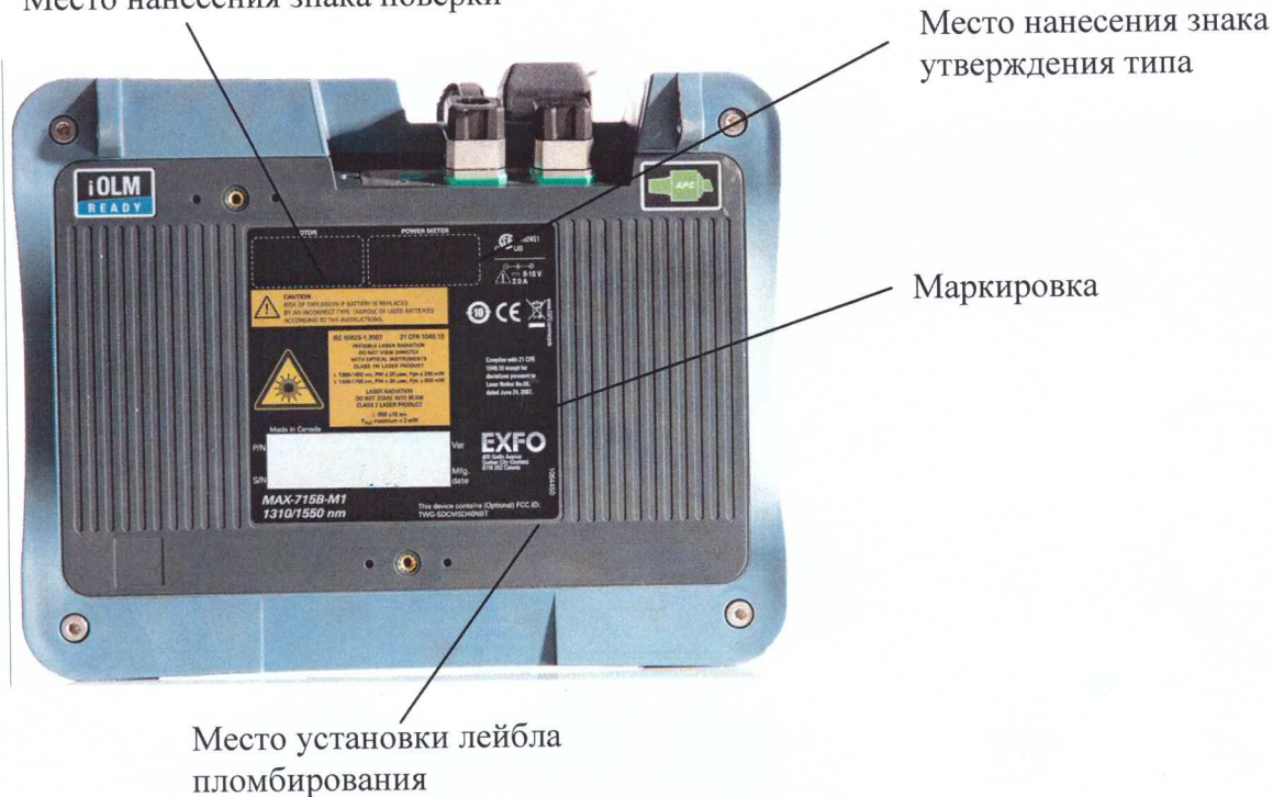
Рисунок 2 - Схема пломбировки от несанкционированного доступа, обозначение места нанесения знака поверки
